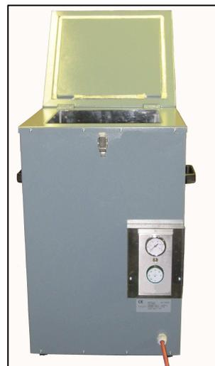
I forni portatili vengono impiegati per mantenere medie quantità di elettrodi, anche di tipo diverso, privi di umidità, per evitare che si formino inclusioni di idrogeno nelle saldature, laddove non possano essere impiegati forni di mantenimento più grandi.
